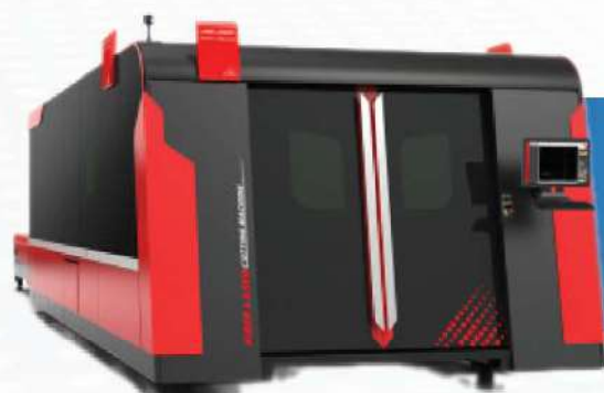
MÁY CẮT FIBER LASER BYSUN BYSTRONIC - Công suất: 6000W - Sử dụng Laser sợi quang nguyên bản - Cắt độ dày vật liệu lên đến 30mm
